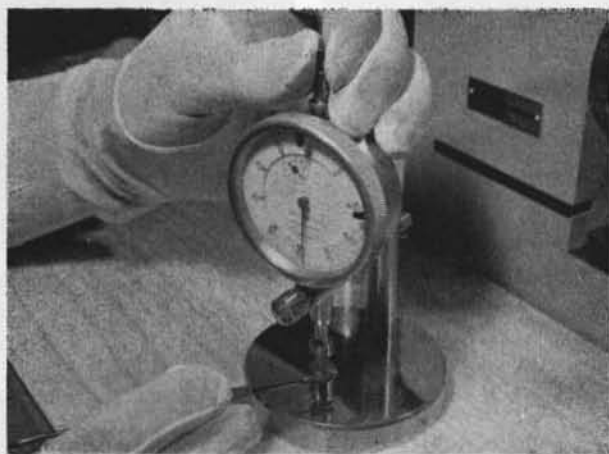
Fig. 15 Espesímetro. Los planos del instrumento, que entran en contacto con el tejido corneal son desprendibles y de acero inoxidable para permitir su esterilización por calor.
