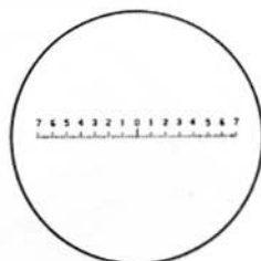
Fig. 7 Reticulo Milimétrico para determinar dimensión de la Aplanación. La lectura se transporta a una tabla, para conocer la tensión exacta.
