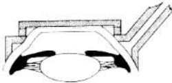
Fig. 5 Esquema de la sección frontal del Microqueratomo y anillo de fijación, la línea de puntos indica la situación de la hoja cortante.
