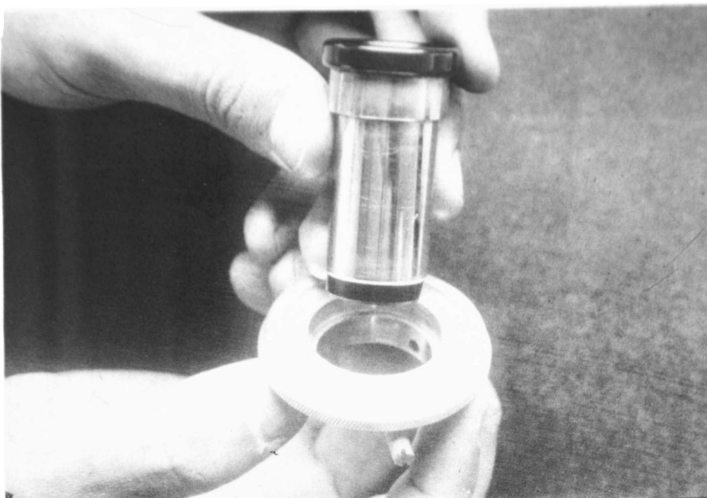
FIGURA 6 Colocando el ocular en el adaptador.
