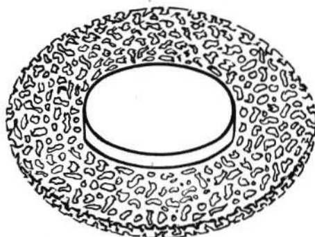
Fig. 12. Lente mixto para inclusión interlaminar según modelo del autor. El área central óptica está elaborada de polimetacrilato de metilo y la aleta periférica, completamente permeable, de esponja de polivinilo.
